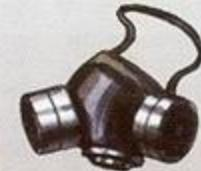
Работы проводить в противогазе (ГП-5, ГП-7, промышленном) или респираторе (РУ-60М, РПГ-67) с фильтрующе-поглощающей коробкой марки Г (одна половина черная, другая желтая).
