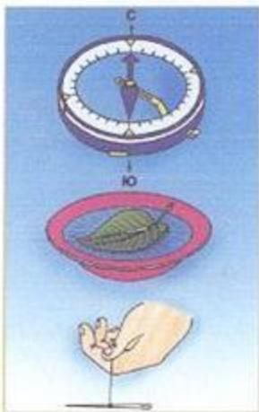
При отсутствии компаса можно использовать намагниченную иголку (булавку, лезвие безопасной бритвы).
