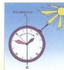
Положить часы так, чтобы часовая стрелка была направлена на солнце. Биссектриса угла, образованного часового стрелкой и направлением на 12 часов, будет линией «север-юг». До полудня юг находится справа от солнца, после полудня – слева.
